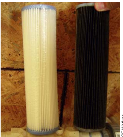
图81.32: 干净的过滤器和被铁和锰堵塞的过滤器。
