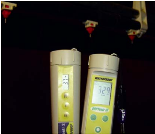
图81.35: 快速测量氧化还原电位（不到2分钟）并且提供有关游离氯残留的数据。
