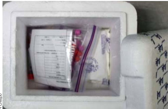
图17.5: 将样本放在防漏的袋中。然后将其放在带冰袋的二级容器中。也建议将二级容器放在一个外包装盒中。向实验室提交适当的信息, 例如饲养场名称、鸡群身份、历史、需要做的检验项目和所提交的样本清单。
